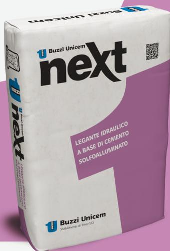
**Buzzi Unicem Next** identifica una famiglia di leganti idraulici a base di clinker solfoalluminato ottenuto mediante la cottura di una miscela di bauxite, gesso e calcare ad una temperatura di circa 1.350°C e la successiva macinazione.
